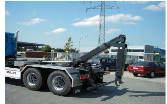
**Die verfügbare Versionen mit einem zusätzlichen hydraulischen Schwenkarm, der den Umfang der Containerlänge und die Möglichkeit seiner Beladung erhöhen.**
